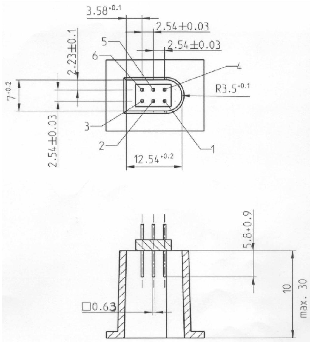
Le schéma suivant illustre une fiche usuelle d'accouplement à 6 broches:
